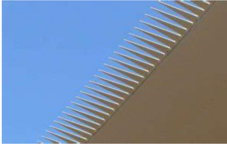
Figure 13 : Technologie de serration des pâles d'un éolienne
